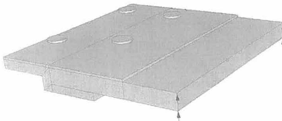
Figura 4.22 – Carregamentos aplicados à geometria do provete experimental.
