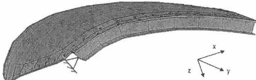
Figura 4.28 – Condição de fronteira aplicada à geometria do cockpit: deslocamento  $u$  segundo a direcção  $x$  na extremidade do perfil em I.
