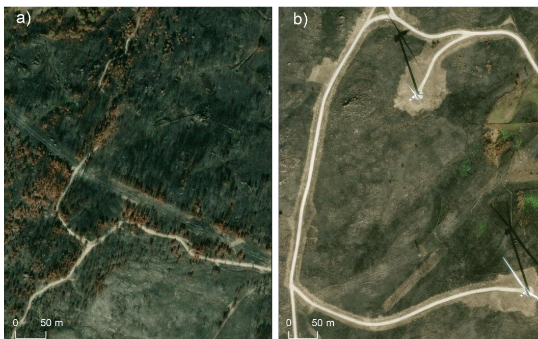
Figura 10 — Exemplo de Faixas de Gestão de Combustível da Rede Secundária executadas e não reportadas, associadas às linhas elétricas no incêndio da Carrasqueira (a) e à Rede Viária Florestal e linhas elétricas no incêndio de Pramigo (b), em ambos os casos sob gestão de entidades concessionárias dos parques eólicos.
