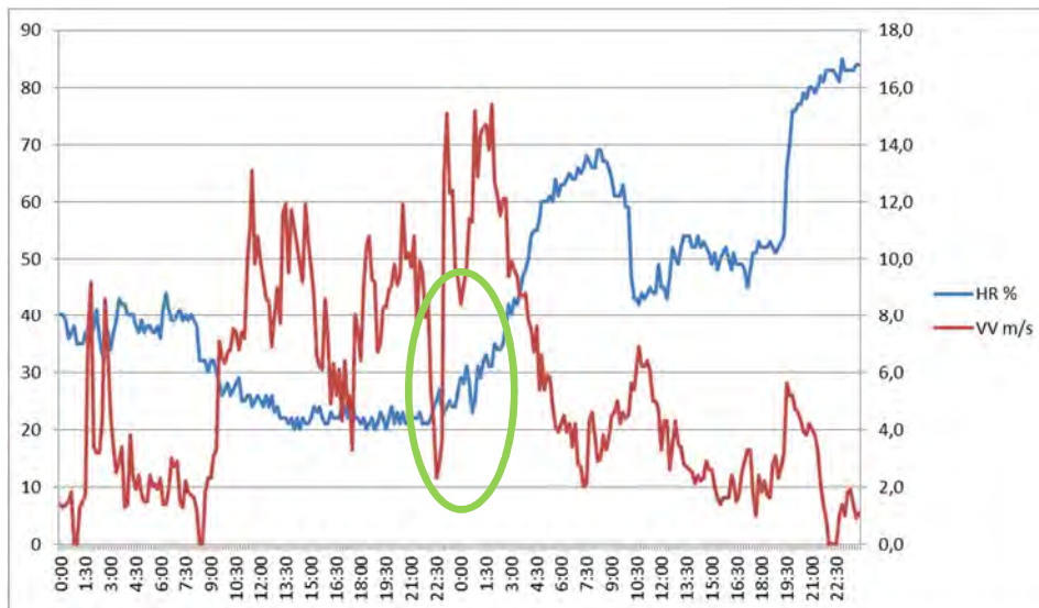
Figura 3.26. Velocidade do vento máxima e humidade relativa do ar (intervalos de 10 minutos) na estação meteorológica de Nelas (IPMA) durante os dias 15 e 16 de outubro de 2017. A elipse assinala a coincidência entre a velocidade mínima do vento, que antecede os valores máximos, e o início da subida da humidade do ar.
